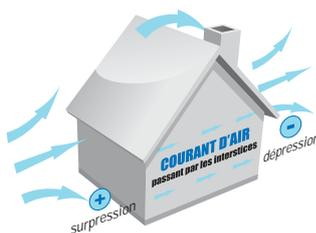
Un bâtiment subit les effets du vent de façon plus ou moins importante en fonction de son emplacement géographique. La qualité de l'enveloppe et son étanchéité au vent vont donc être essentielles pour éviter que, sous la pression du vent, l'air ne s'infilte par les défauts de la construction.
