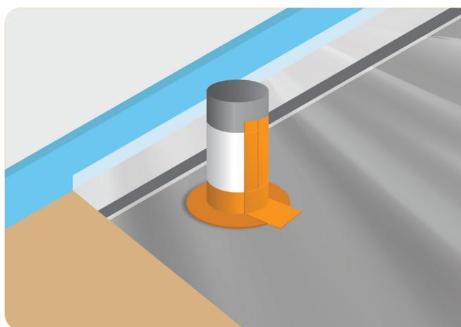
Désolidariser les canalisations traversant les planchers par des manchons formés par des bandes résillientes.
