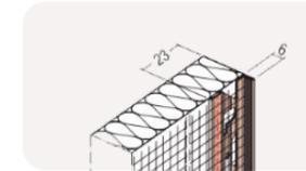
**Profil entoilé à clipser pour arrêt latéral d'enduit PVC**
